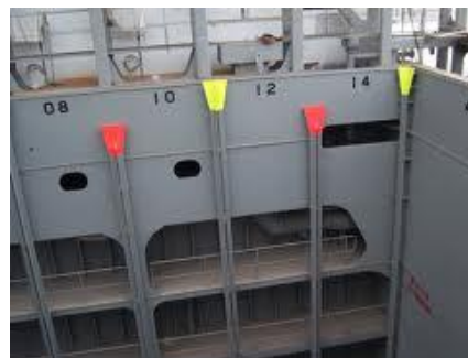
FIGURA F.F2.107.2 – CELL GUIDE SUPERIOR EM UM TANQUE DE UM NAVIO PORTA CONTAINER
